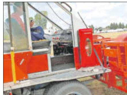
*Hier die Röttger-Schleppwinde mit Kunststoffseilen, 2 Seiltrommeln je 1200 Meter; 1 V8 CM-Motor mit 270 PS und Automatikgetriebe. Hiermit erreichen die Segelflugzeuge eine Höhe von 450 bis 650 Meter.*
