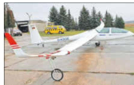
*Segelflugzeug DG 1000 T, doppelsitziges Segelflugzeug, Spannweite 20 m, Bauweise aus GfK Gleitzahl 46,6, Höchstgeschwindigkeit 270 km/h, ausgerüstet mit einem Turbo (Klapptriebwerk mit Zweitaktmotor), mit dem Klapptriebwerk ist es möglich auch bei abgeschwächter Thermik zum Startflugplatz zurück zu fliegen. Ausklappen, anlassen und ab nach Hause.*
